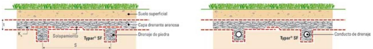
Figura 32: Sección de dos capas drenantes diferentes que utilizan DuPont™ Typar® SF.
